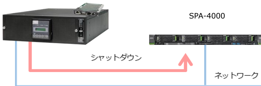
UPSS-A3/X2シリーズ(LAN I/Fカード実装)検証構成
